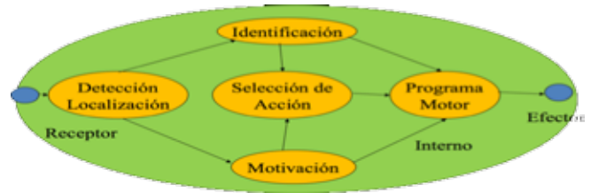
Figura 2. Etapas de procesamiento en un ser vivo y en una máquina
